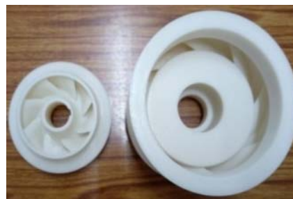
Fig. 13. Impeller stacking 10^\circ .
