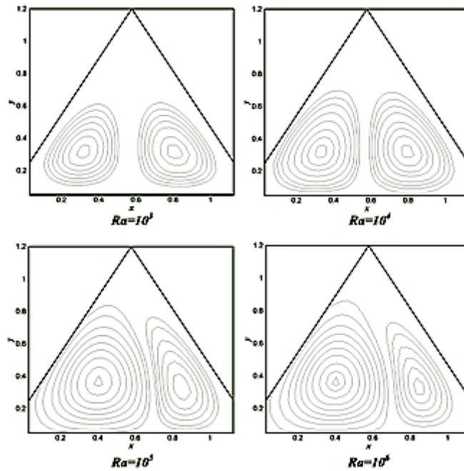
Fig. 5. Streamlines for  $A_w=0.25$ ;  $Ra=10^3$ ;  $10^4$ ;  $10^5$ ;  $10^6$
