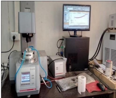
Fig. 3. Anton-Paar modular compact rheometer (MCR-102).
