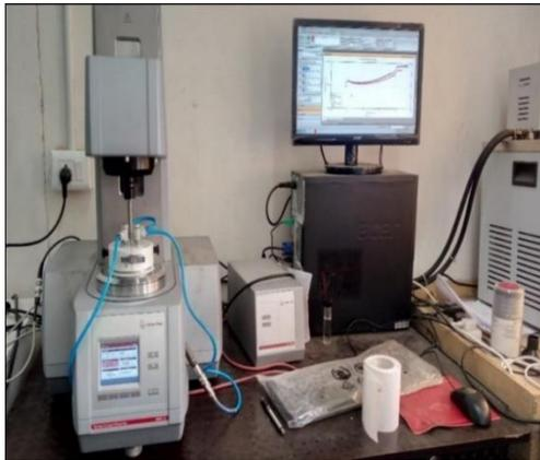
**Fig. 3. Anton-Paar modular compact rheometer (MCR-102).**
